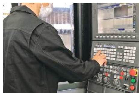
マシニングセンタによる加工（オークマNB-56VA）
