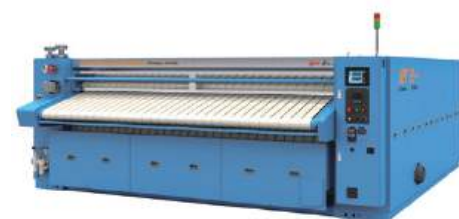
ロール・アイロナー (大型シートを連続乾燥・仕上げ)
