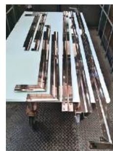
板金製作物 扉周囲のゴム押さえ (材質はステン)
