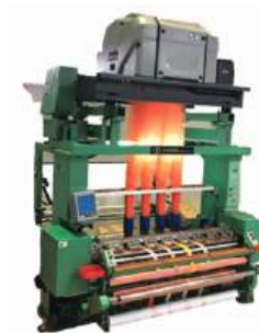
ストーブリジャガード搭載織機
