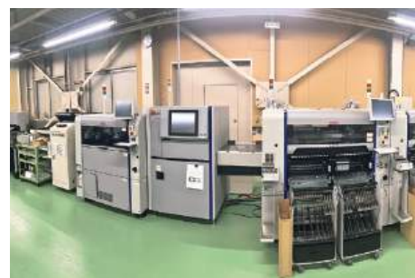
RoHS2対応プリント基板実装ライン
