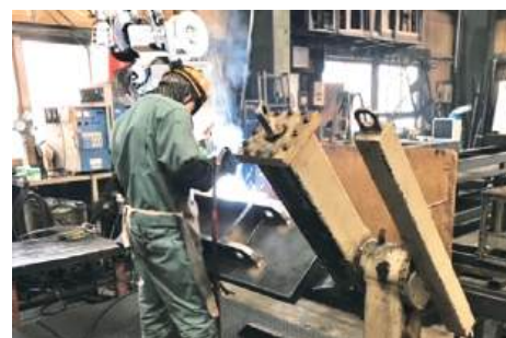
自社製作のポジショナーを使用しての溶接
