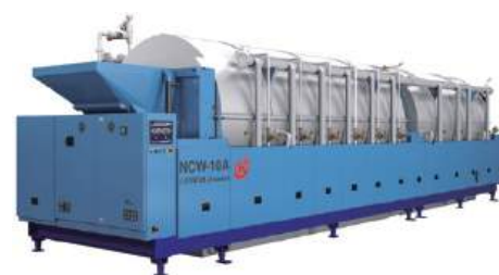
連続式洗濯機 (時間 800 ~ 1000kg の連続処理)
