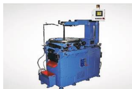
キー溝加工機：TK-250NS-AF-II
