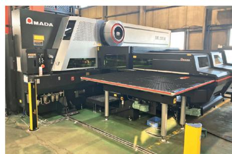
レーザー加工機（鋼板の切断、穴加工）
