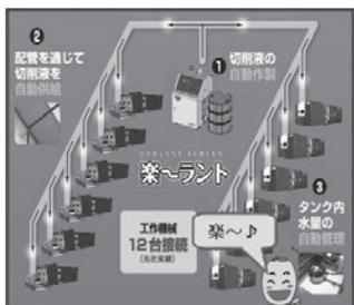
クーラントサーバー『楽〜ラント』は、当たり前とされている人手によるクーラント作業を『ムダ』と捉え、複数台の工作機械への補充を完全自動化するものです。水と切削液原液を混合し、希釈、攪拌、補充を無人化します。重たい運搬もありません。『水道法適合品』なので、水道配管との接続が可能です。
